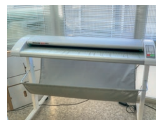
Durchlauf-Scanner für großformatige Vorlagen bis DIN A0
